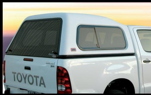
Većina vozila s duplom kabinom ima izbor klasičnog standardnog krova koji je u visini kabine vozila ili visoki krov koji maksimizira unutarnje dimenzije za veći teret. Hardtopovi za vozila s jednostrukom kabinom ili ekstra kabinom dostupni su i u varijanti s visokim krovom. Hardtopovi s standardnim krovom mogu se opremiti krovim nosačima.
