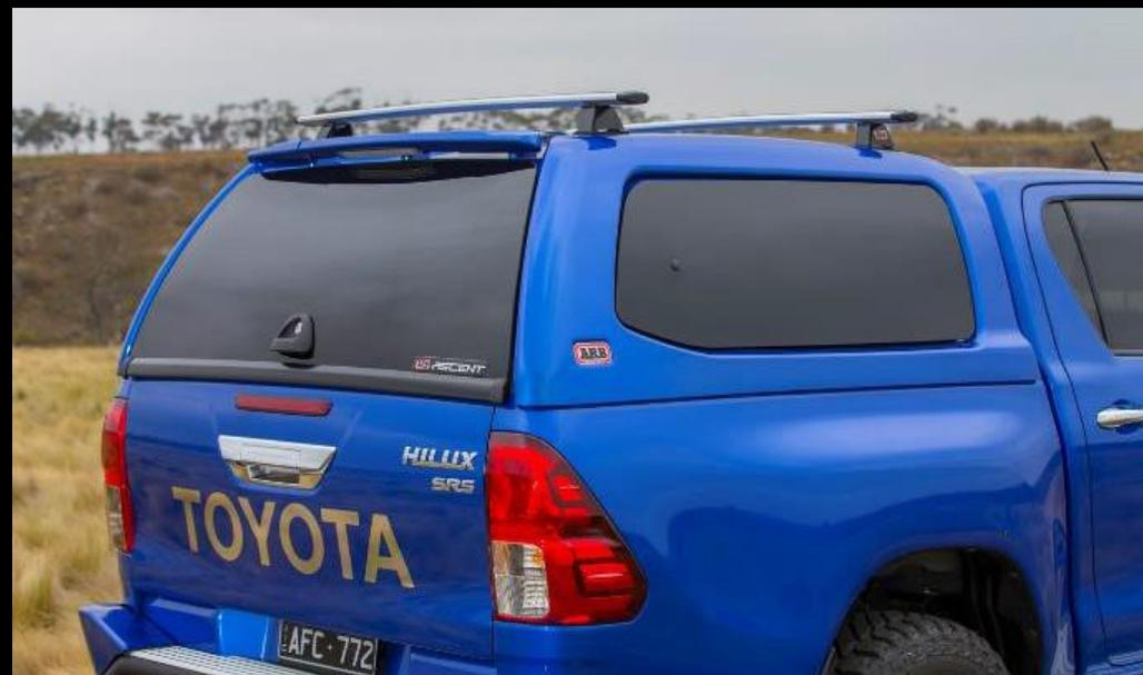
Veliki izbor krovnih nosača omogućuju nosivost do 100kg (kolika je preporuka proizvođača vozila). Sastoje se od para krovnih nosača koji nude dodatnu snagu i jednostavnost za korištenje.
